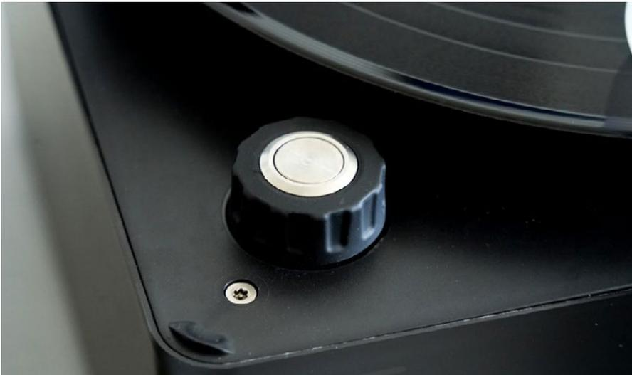
**Handlich:** die Platte dreht in die Richtung in die man den Schalter dreht. Der Druckschalter in der Mitte startet die Absaugung (Foto: R. Vogt)
